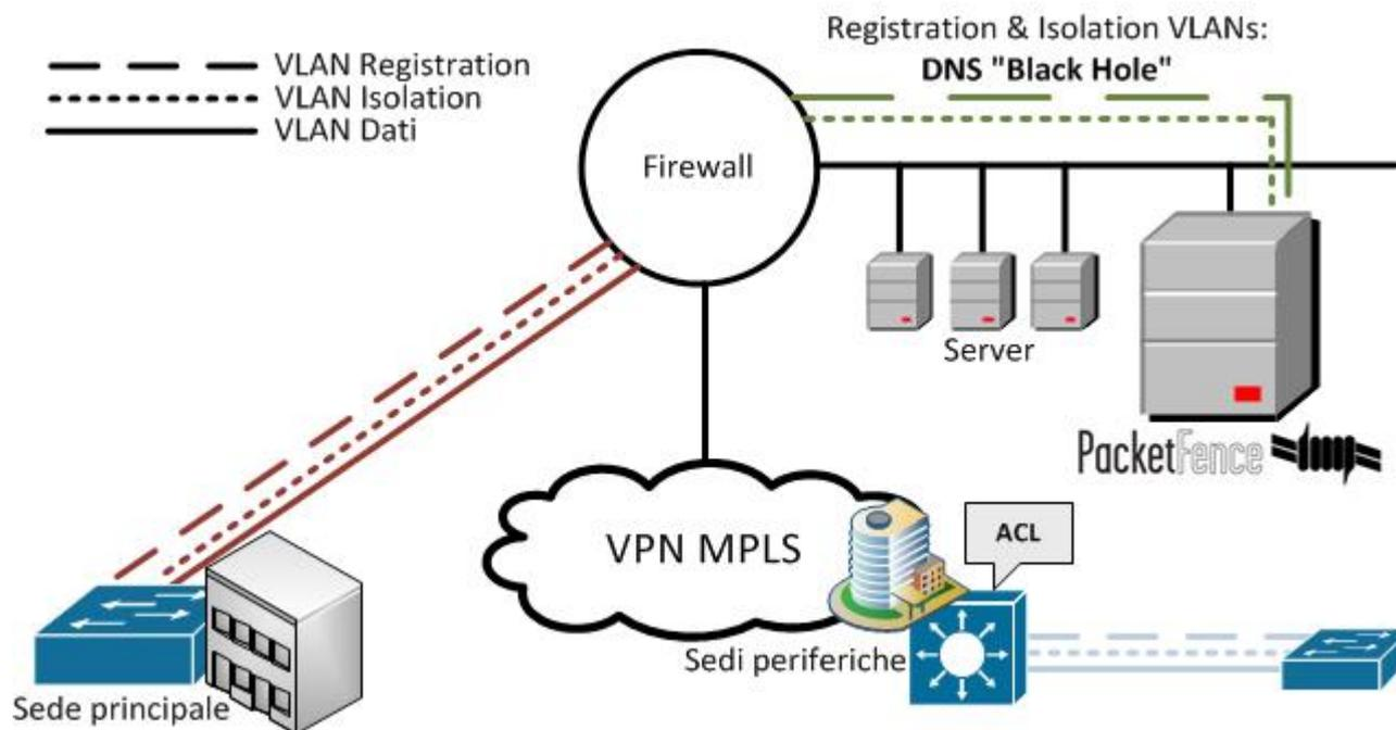
Le politiche di sicurezza vengono implementate tramite i dispositivi di rete, gestendone la configurazione delle porte (**VLAN enforcement**) in modo che il client non autenticato (assegnato alla vlan di **registration**) non possa effettivamente fare nulla (attacchi, scansioni di porte, DoS ecc) finché non è stato ammesso in rete.
